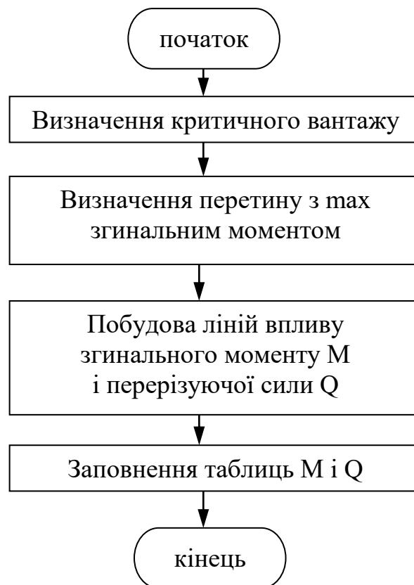
Рисунок 3.9 – Блок-схема алгоритму розрахунку згинального моменту і перерізуючої сили
